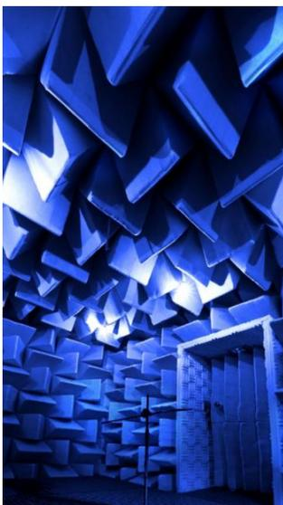
Guillemot Corporation possède une salle anéchoïque de niveau professionnel pour la mise au point de sa gamme de haut-parleurs multimédias, haut-parleurs DJ et la gamme d'enceintes avec technologie sans fil Bluetooth®. Cette salle, dite « chambre sourde », est recouverte de dièdres en matériaux poreux sur toutes ses parois pour mesurer les ondes acoustiques sans qu'il y ait de perturbations liées à la réflexion et donc recréer des conditions dites « de champs libres ».
